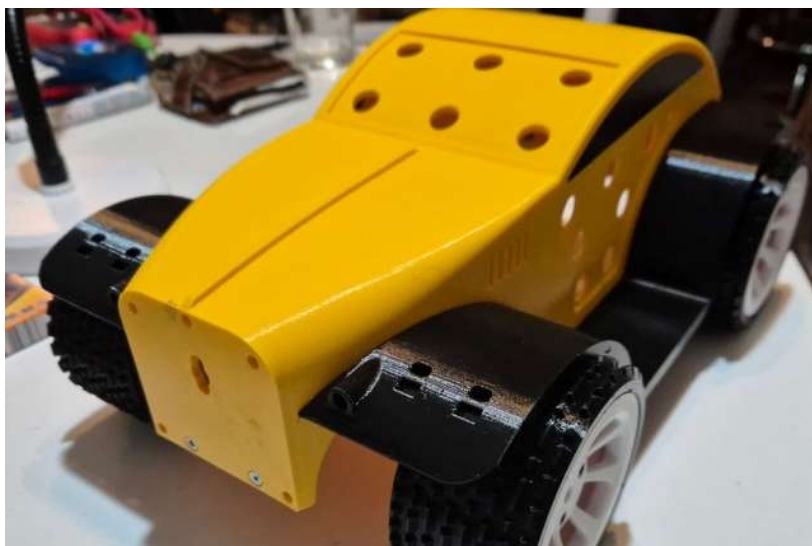
Využití 3D tisku pro řešení vnitřní dispozice karoserie RC automobilu
