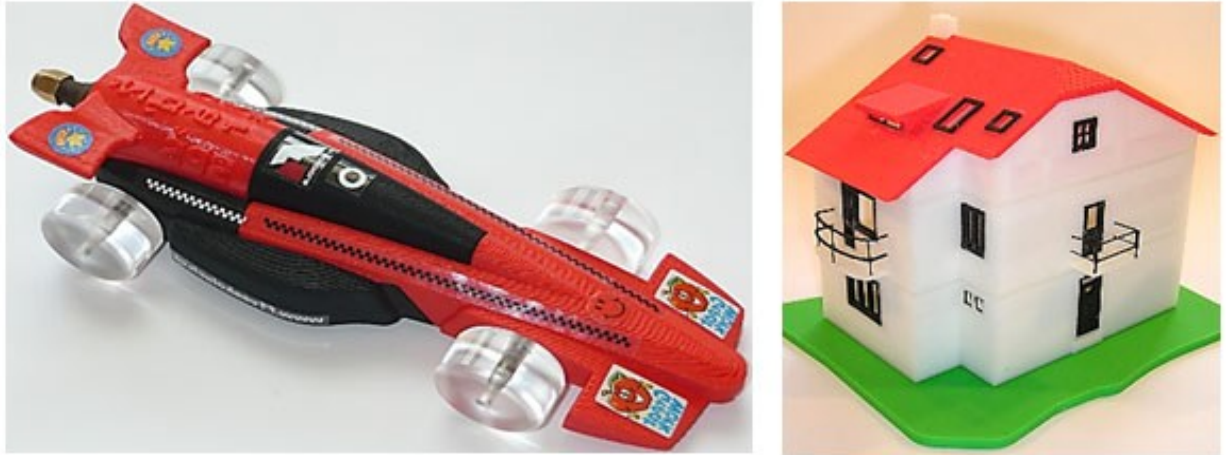
3D modely zhotovené metodou FDM - postupného nanášení tenkých vrstev termoplastu
