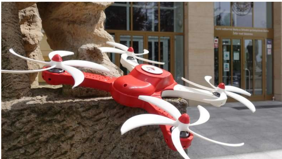
První koncepční návrh vyrobený s využitím 3D tisku s maketovými vrtulemi
