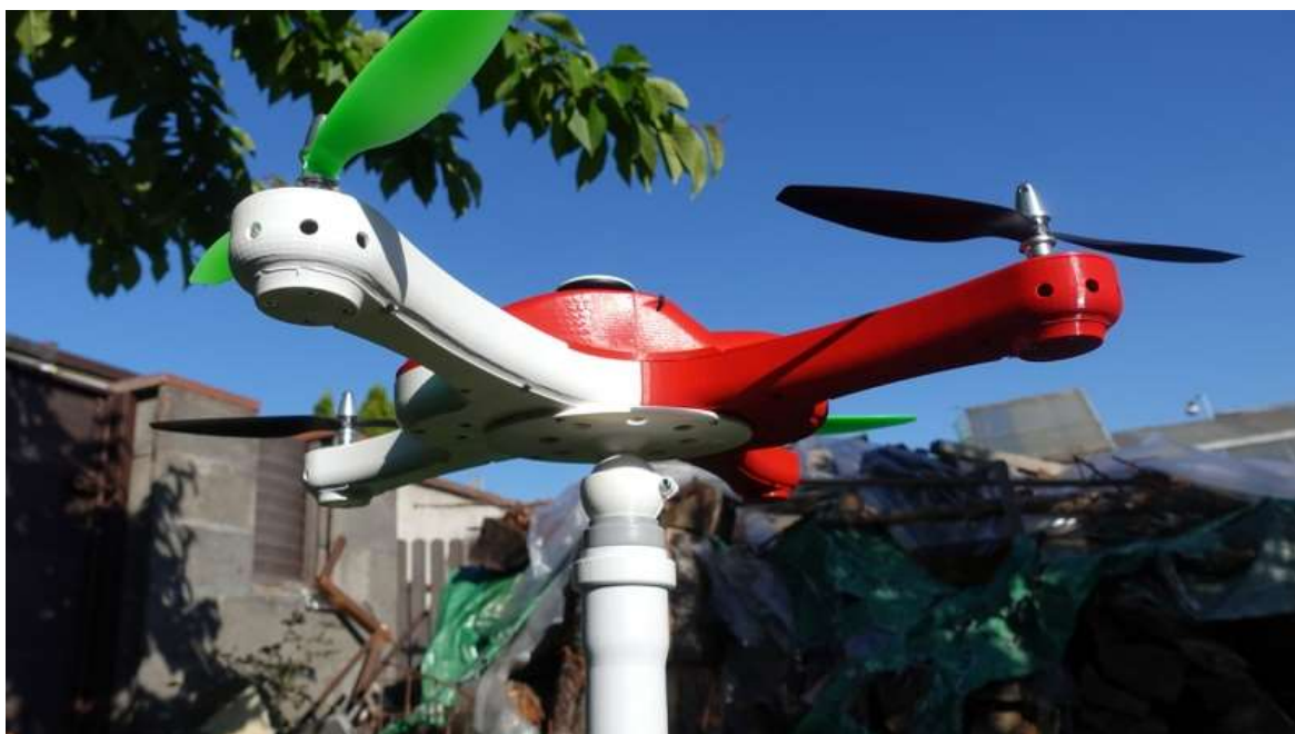
Testovací sestava pro měření účinnosti pohonu na speciálním kloubovém standu
